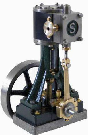
an, vient de terminer la réalisation du moteur **V10** de chez STUART, ceci à partir d'un kit. C'est son premier moteur, et pour cela, il a dû maîtriser d'une part les plans en unité impériale, et d'autre part le fraisage, le tournage et l'ajustage. Le résultat est plutôt édifiant, et d'une finition très soignée.
