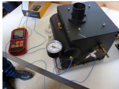
La chaudière est capable de fournir 3 litres de vapeur à l'heure sous 4 bars effectifs. Nous devons sécuriser l'ensemble car, en 10 mn, le ballon supérieur de la chaudière
