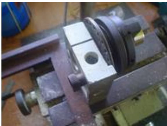
moyeu : bien caler le diviseur pour des trous parallèles
