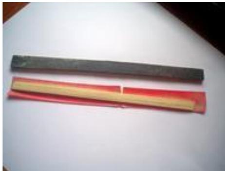
Les **virures** sont en bois de placage de 3 x 0.6. On les pose sur du collant d'électricien et on les effile de chaque côté avec une lime "maison" (papier de verre collé sur une baguette): **abattre la moitié de la largeur en bout en partant du centre.**
