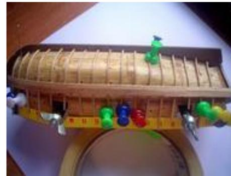
Pour la pose, après vérification de la virure, **enduire complètement** une face de colle blanche, caler avec une forte pince un côté dans la râblure de l'étrave et appuyer la virure sur les membrures avec des épingles.
