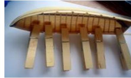
Les membrures qui dépassent sont coupées à 1/2 mm du bordé supérieur avec un coupe-ongles. On peut alors coller le plat-bord où on a préparé à la lime les **tolets** qui permettent le positionnement des rames.
