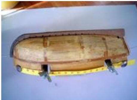
On distingue le passage des membrures En bas du moule, petite règle en carton pour que les membrures soient bien d'équerre.
