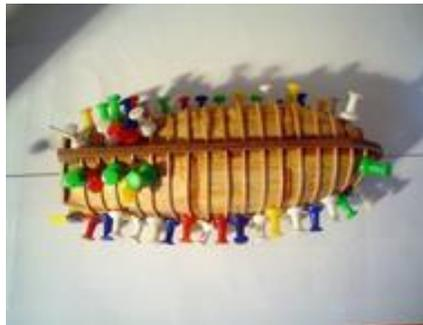
Les membrures en une seule pièce (baguettes de 1 x 1) sont **glissées** dans leur passage puis pliées de chaque côté. Elles ont au préalable passé 1 heure dans l'alcool à brûler. Les essuyer avant de les glisser, mettre un point de colle blanche sur le dessus de la membrure à l'endroit où elle se placera dans l'échancrure, pousser, plier doucement en même temps de chaque côté en partant du centre.
