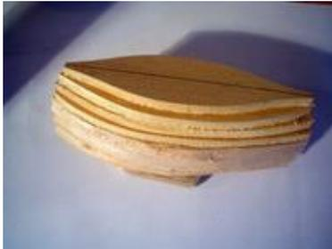
La première expérience ayant montré qu'il ne fallait pas craindre le démoulage, le moule de la plus petite embarcation est obtenu par collage de tranches d'un bois assez tendre (matériel fourni par AL).
