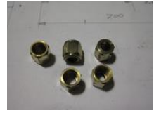
après reprise et nettoyage les écrous sont prêts
