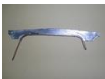
Soudure du renfort de la "casquette" à l'avant de la cabine.
