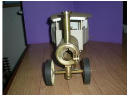
Aspects de la boîte à fumée posée (le raidisseur n'est pas en place) :
