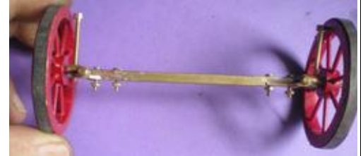
Principe de la fixation de l'essieu sur la suspension.
