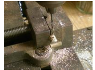
Perçage à 1.6 avant taraudage à M2.
