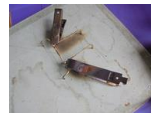
montage pour la brasure à l'argent
