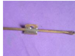
Soudure à l'étain du guide du doigt de direction.
