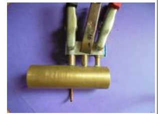
montage avant soudure pour l'alignement
