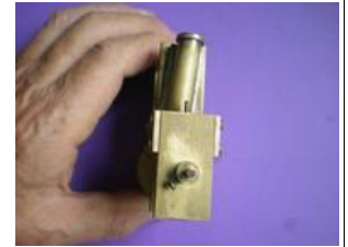
une tige de 3 doit tourner même sans roulements
