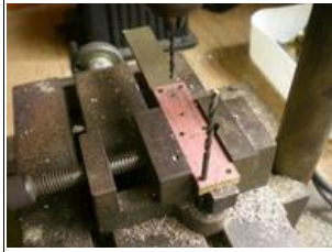
perçage du second flanc
