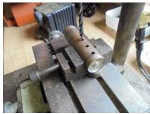
perçage après soudure des fonds
