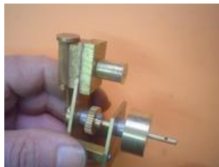
un tube dissimule le ressort
