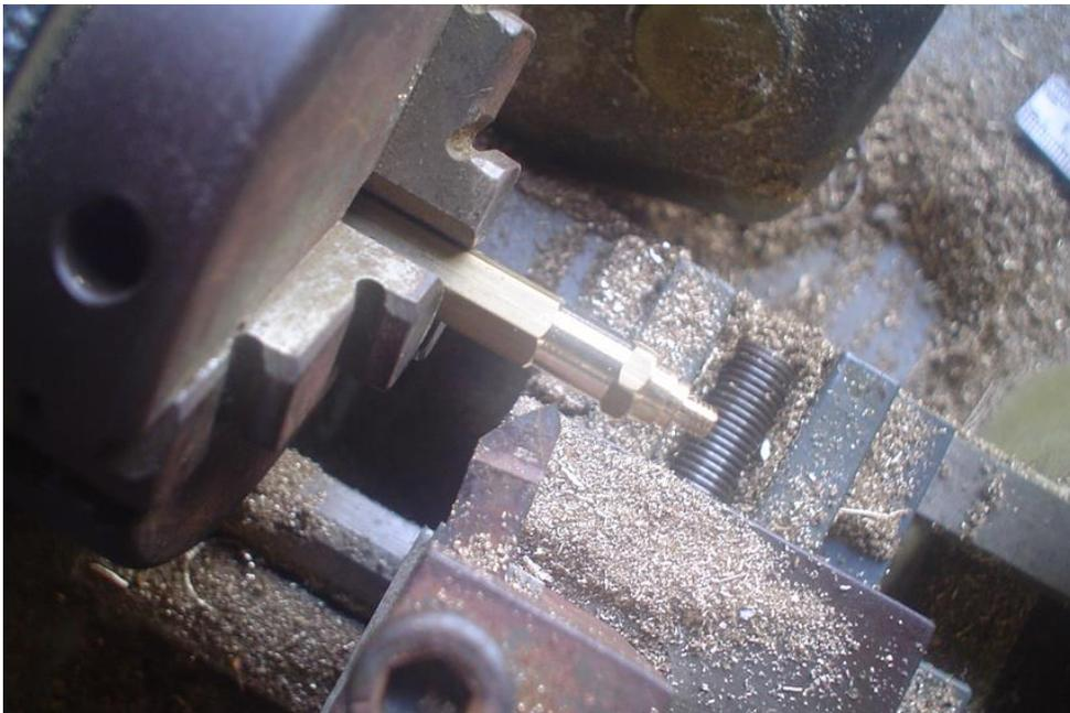
La pièce toujours en place dans le mandrin, placer un écrou : il doit aller jusqu'à l'épaulement ... reprendre avec l'outil à tronçonner jusqu'au bon fonctionnement.
