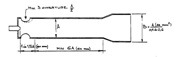
La puissance calorifique du brûleur est principalement fonction de sa section B.
