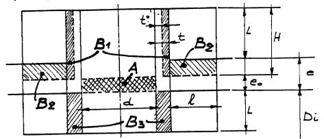
L'aire de compensation B ( $B_4 + B_2 + B_3$ ) est au moins égale à l'aire à compenser A.
