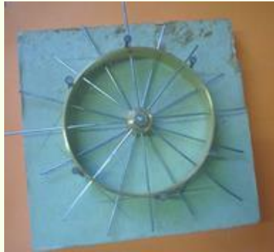
mise en place des rayons
