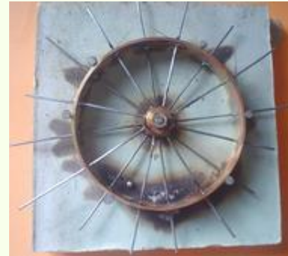
opération soudure terminée
