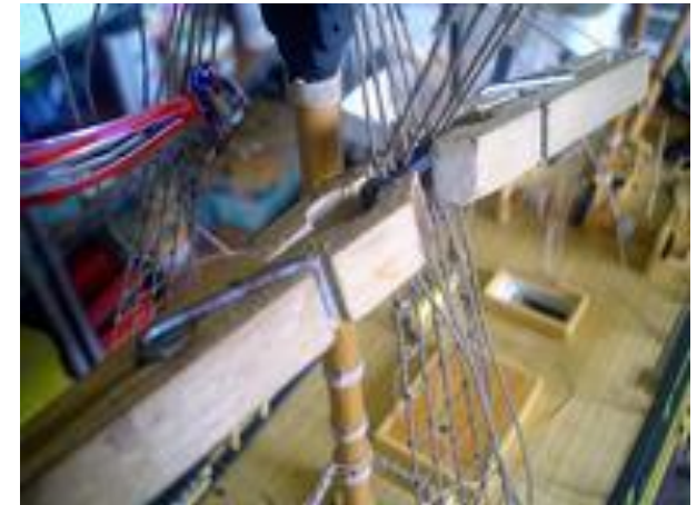
Mise en place et collage de la seconde pièce de bois, également rainurée.
