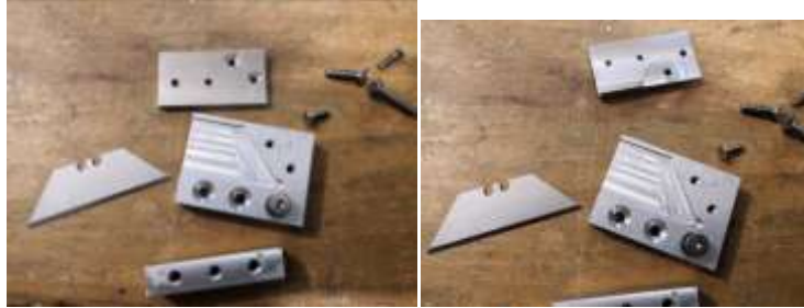
...et ses pièces constitutives (Le petit L de la pièce de dessus sert à éviter la rotation de la lame, j'avais fraisé un peu large !) Le tout en Aluminium et vis Inox.
