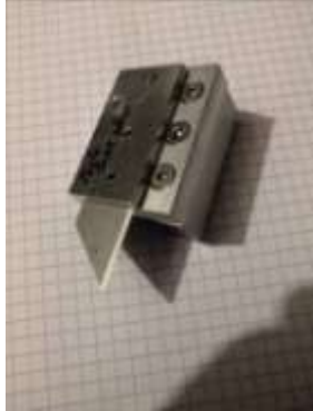
Le Porte-cutter... (La lame de cutter est serrée par 2 vis sans tête avec une clé à lène)
