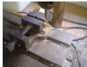
perçage : d'abord de part et d'autre à 1.6, puis reprise du premier trou à 2 et finition du second trou à M2 - petit réglage de la position déjà vue pour que ce soit perpendiculaire
