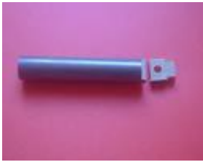
désolidariser la chape du rond de laiton à la scie fine
