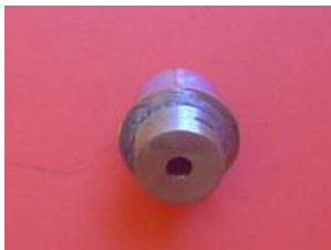
effectuer un trait de scie au milieu de cette "empreinte" : c'est la position à 90° de notre excentrique
