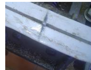
autre petit truc pour réaliser les fentes pour le vissage : les mordaches en aluminium permettent un bon maintien et on peut les exécuter à la scie fine
