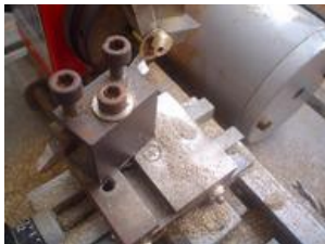
mise à l'épaisseur des ronds, puis grattage à la main de la soudure du rond le plus petit
