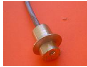
soudure sur 2 ème rond de 10 avec tube d'aluminium pour le maintien
