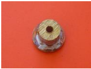
souder rondelle et rond le plus long sur les faces usinées (étain)
