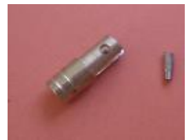
en se servant du trou , positionnement de la fraise de diamètre 2 pour réaliser la mortaise
