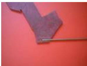
1 ère solution , pas très élégante il est vrai : brasage sur la tige de 2 d'un plat de laiton d'épaisseur 2 ; percer les deux trous, tracer, découper puis braser, finir à la meule
