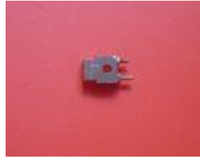
perçage des trous (foret adapté au futur pas de vis) en bout de chape pour serrage
