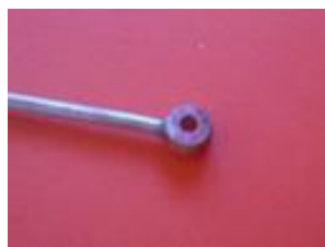
reprendre le trou central puis scier de part et d'autre à ras de la tige ou plus loin avec finition à la fraiseuse ou à la lime
