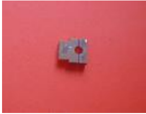
scier , si possible au milieu, la chape
