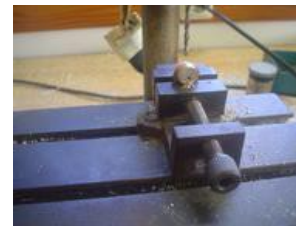
percer en s'aidant de ce repère les trous pour le filetage sur le rond non excentré (1.6 pour M2)
