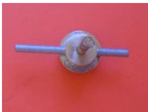
visser deux restes de vis M3 en acier avec un bout de laiton de diamètre 3 au centre, puis scier à ras
