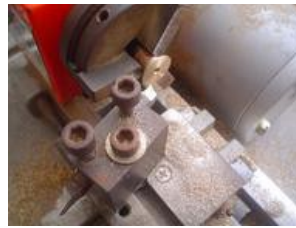
amener la rondelle à l'épaisseur désirée, ici 0.5 mm
