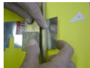
Pliage en appuyant fortement sur la cale et le tube : on pourrait aussi prévoir un montage pour le serrage ...
