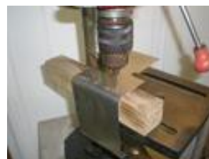
On procède ensuite au perçage des deux tôles : alignement des trous garant.
