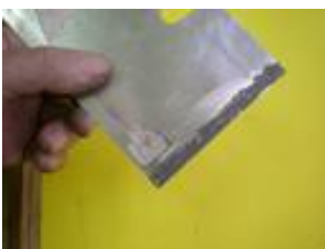
Poncer puis nettoyer à l'acétone les endroits où les tôles seront en contact et enduire de mastic la tôle intérieure (il vaut mieux procéder à un repérage des tôles au fur et à mesure du perçage).
