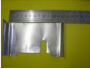
Vérification de la côte intérieure (ici 120 mm)
