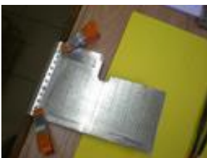
Essayer de tracer les côtés est source d'erreur. Il vaut mieux repérer deux trous aux extrémités sur la tôle de côté, percer puis clouer la tôle arrondie au dessus du flanc sur un bois.
