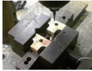
Opération de repérage avec une petite fraise ... de dentiste.
