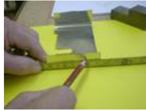
Traçage de la partie excédentaire : un réglé convient dans ce cas, mais ce pourrait être un trusquin.
