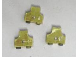
Il ne restera plus qu'à percer puis tarauder pour la tige du piston.
