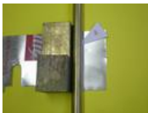
Traçage sur la tôle (hauteur coupée à la bonne dimension, largeur plus grande pour faciliter le pliage) : . en A les repères pour la pose de la cale . en B traçage des découpes éventuelles à effectuer avant le pliage
