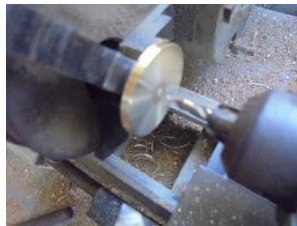
arrondir à 24 et pointer le centre, puis tracer
