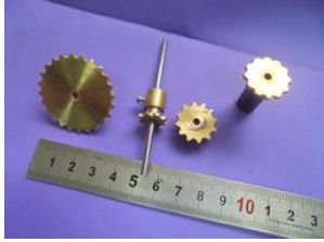
les 4 pignons réalisés
