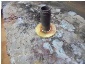
montage à l'étain pour l'usinage
