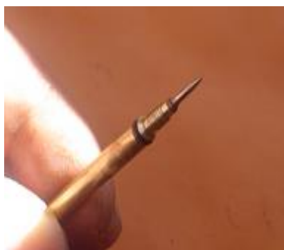
ajout d'un joint torique
