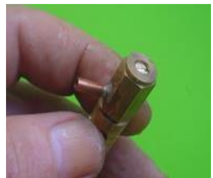
fente sur le pointeau pour le réglage
