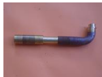
tube de 5 x 6 enfilé et tube de 6 x 8
