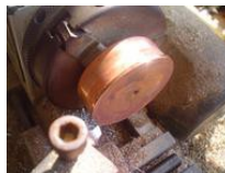
Reprise au tour : pièce maintenue par le téton central.
