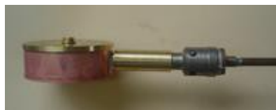
Elle est ici réduite à 14 mm et on doit pouvoir encore la diminuer alors que le champignon monté donne, au mieux, 30 mm ... Ce qui m'avait obligé à découper le support d'un groupe pour positionner ce brûleur à la bonne hauteur : sinon, chaudière inopérante !
