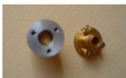
Liaison entre la bague de camping-gaz et l'arrivée vapeur : fixation par 3 vis de 1.6 à 120° dans des trous taraudés dans la bague filetée.
