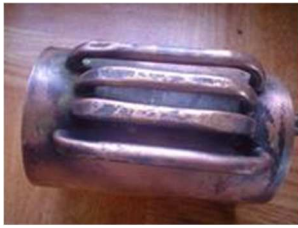
Les tubes bouilleurs : vous pouvez constater qu'ils ont beaucoup soufferts lors du positionnement !!!
