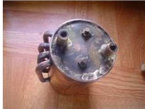
Les tubes bouilleurs : vous pouvez constater qu'ils ont beaucoup soufferts lors du positionnement !!!
