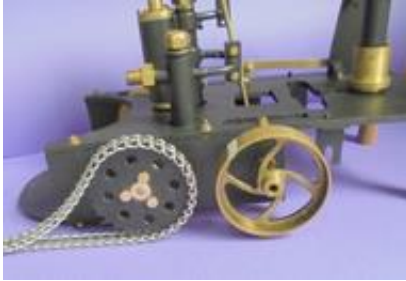
Montage d'une roue pour l'entraînement d'une chaîne : bateau à roue arrière - version 2 (système Meccano).
