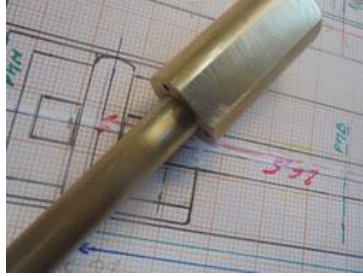
perçage et rodage du rond de 8 (piston)
