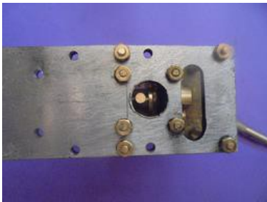
arrivée vapeur, gougeons qui ne doivent pas serrer le foret de 5
