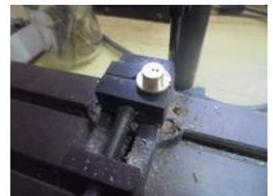
Il reste à percer le trou de 3 pour le passage de l'axe
