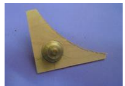
Il reste à percer le trou de 3 pour le passage de l'axe
