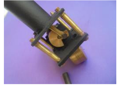
redresser puis bloquer tous les écrous (rondelles)
