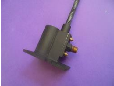
arrivée vapeur, gougeons qui ne doivent pas serrer le foret de 5
