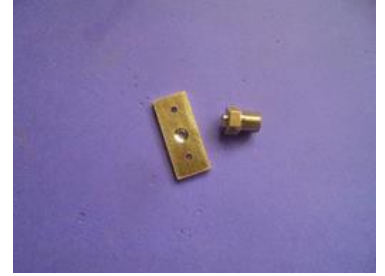
le perçage à 4 pour la fixation du raccord
