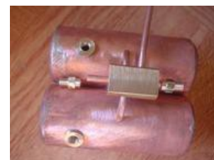
Prêt pour la brasure du bloc de distribution ...
