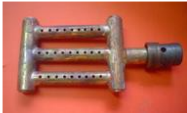
brûleur avec 3 tubes et le porte-gicleur de camping-gaz pour les essais
