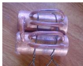
Prêt pour la brasure des fonds et des tubes ...
