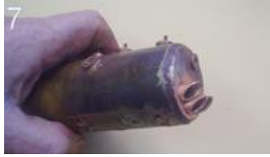
7 - mini-chaudière à tubes de fumée une idée en attente de charbon
