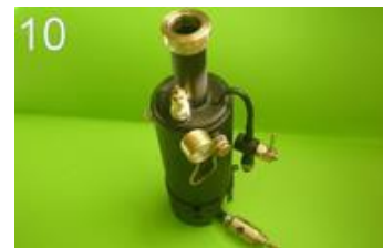
10 - mini-chaudière verticale mixte
