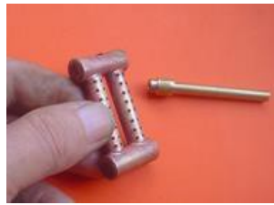
perçage puis brasure de l'arrivée de gaz
