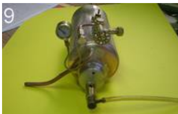
9 - mini-chaudière à foyer central
