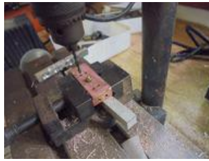
perçage à 3 de profondeur
