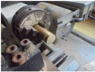
dresser une face, scier une rondelle de 4 d'épaisseur
